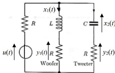
indichiamo con  $x_1(t)$  la corrente che attraversa l'induttore e con  $x_2(t)$  la tensione ai capi del condensatore. Sia inoltre  $u(t)$  la tensione applicata dal generatore di tensione ideale al circuito, mentre  $y_1(t)$  e  $y_2(t)$  le tensioni ai capi di woofer e tweeter, rispettivamente. Le equazioni di stato e uscita che descrivono il circuito elettrico sono<sup>1</sup>:
