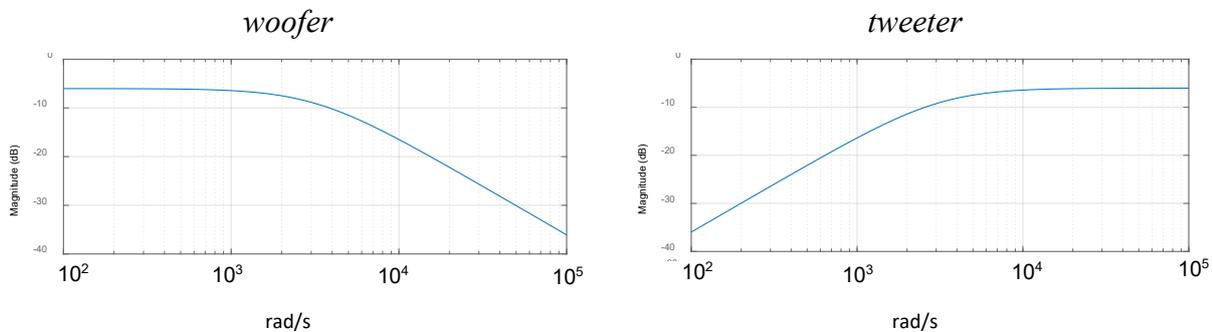
La banda passante (delimitata superiormente da  $Bp\_woofer$  e inferiormente da  $Bp\_tweeter$ , per il woofer e tweeter, rispettivamente) è ora circa data da  $\omega_{cr} = 3.14 \cdot 10^3 \frac{\text{rad}}{\text{s}} \rightarrow f_{cr} = 500 \text{ Hz}$
