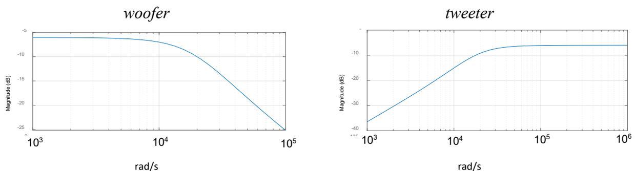
I rami del circuito di woofer e di tweeter si comportano come filtri passa basso e passa alto, rispettivamente. L'estremo superiore della banda passante per il woofer ( $Bp\_woofer$ ) è pari a  $1.7211 \cdot 10^4$  rad/s, mentre l'estremo inferiore della banda passante per il tweeter ( $Bp\_tweeter$ ) è pari a  $2.0603 \cdot 10^4$  rad/s.
