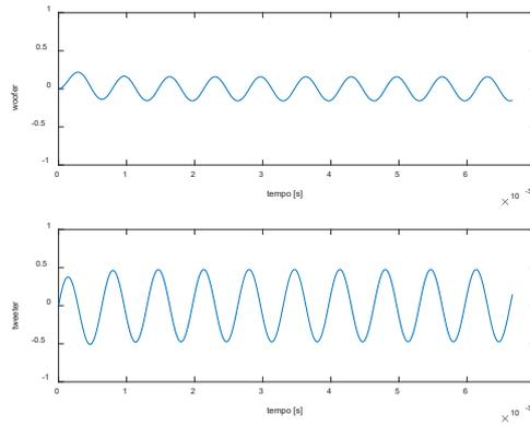
La simulazione mostra il risultato atteso: il segnale di ingresso viene filtrato dal woofer e passa bene nel tweeter. Si può anche ascoltare con `sonoro_f(1000, R, L, C)`, oppure ripetere l'esperimento per frequenza pari a 2000 Hz. Al contrario, segnali in ingresso con frequenza inferiore a 500 Hz sono filtrati dal tweeter (`sonoro_f(200, R, L, C)`). Si può infine ascoltare l'effetto relativo a un ingresso con frequenza variabile da 100 a 2000 Hz con `sweep(R, L, C)`.
