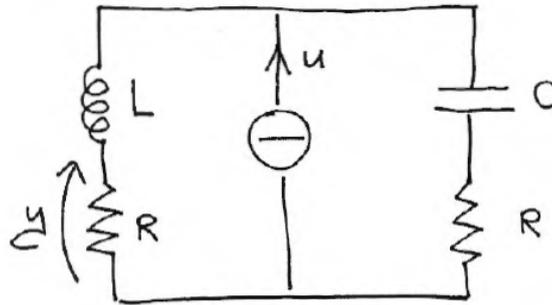
a) Descrivere la rete elettrica mediante un sistema dinamico a tempo continuo di ordine opportuno, specificando le equazioni di stato e di uscita.
