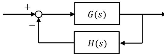
in cui  $G(s)$  rappresenta la funzione di trasferimento del sistema assegnato e  $H(s)$  la funzione di trasferimento di un integratore.
