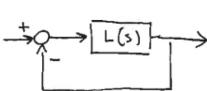
avente funzione di trasferimento d'anello  $L(s)$  propria, con  $L(s) = \frac{\mu}{s^2} \frac{\prod_i (1+s\tau_i)}{\prod_j (1+sT_j)}$
