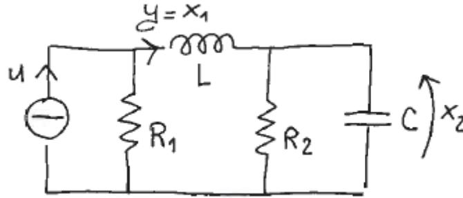
a) Si descriva la rete elettrica mediante un sistema dinamico lineare a tempo continuo, scrivendo le equazioni di stato e l'equazione di uscita. Si specifichi poi la quaterna di matrici  $(A, b, c, d)$  corrispondente.
