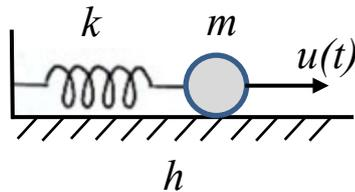
Alcune prove consistono nell'applicare alla massa una forza di ingresso  $u(t)$  sinusoidale di ampiezza unitaria con pulsazione  $\omega$  e nel rilevare l'ampiezza  $Y$  della velocità  $y(t)$  a transitorio esaurito della massa stessa. I risultati sono riportati in tabella:
